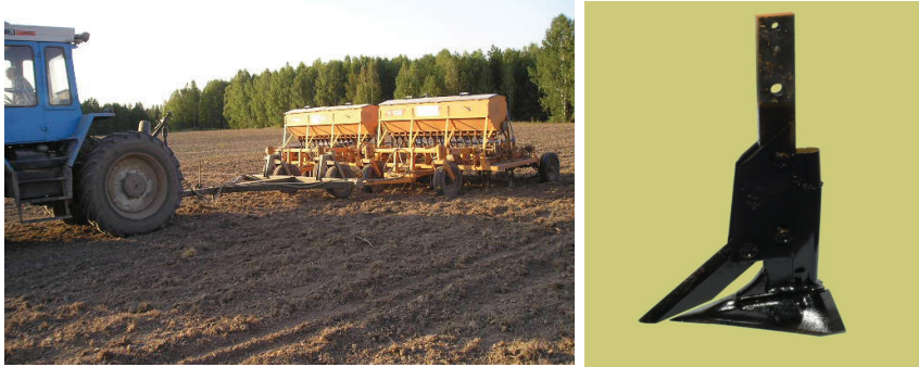
Рисунок 2. Общий вид агрегата из двух сеялок ССВ – 3.5 с экспериментальными сошниками (а) и экспериментальный сошник (б)
