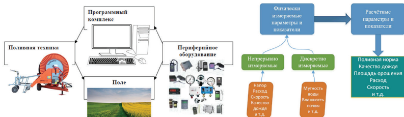
Рис. 1. Оперативное управление орошением: а) обобщенная схема; б) параметры и показатели при мониторинге работы оросительной системы
