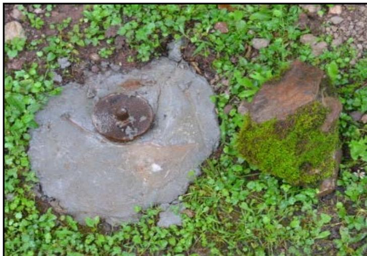
**Рисунок 4 – Установка опорных реперов в толще горных пород**
