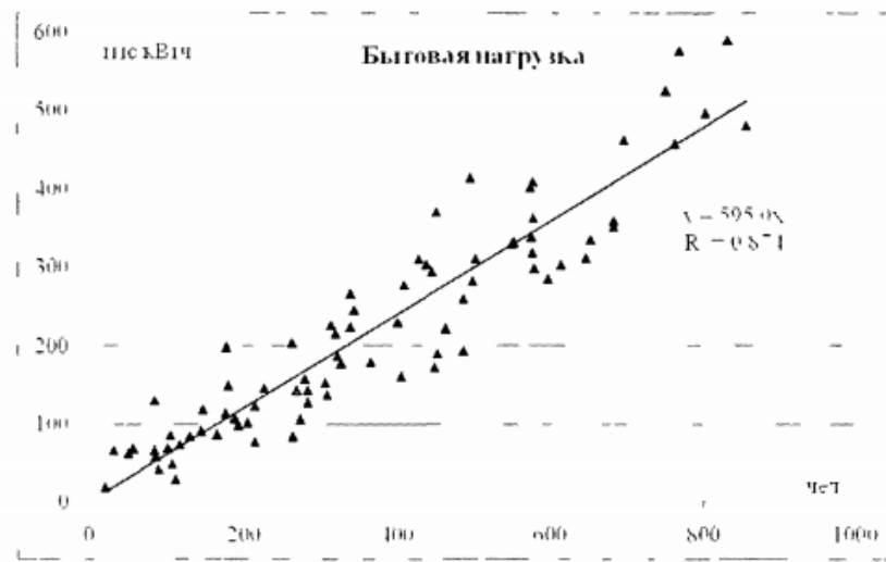
Рисунок 5. - Фактическая зависимость годового потребления электроэнергии (бытовая нагрузка) от численности населения автономных систем электроснабжения
