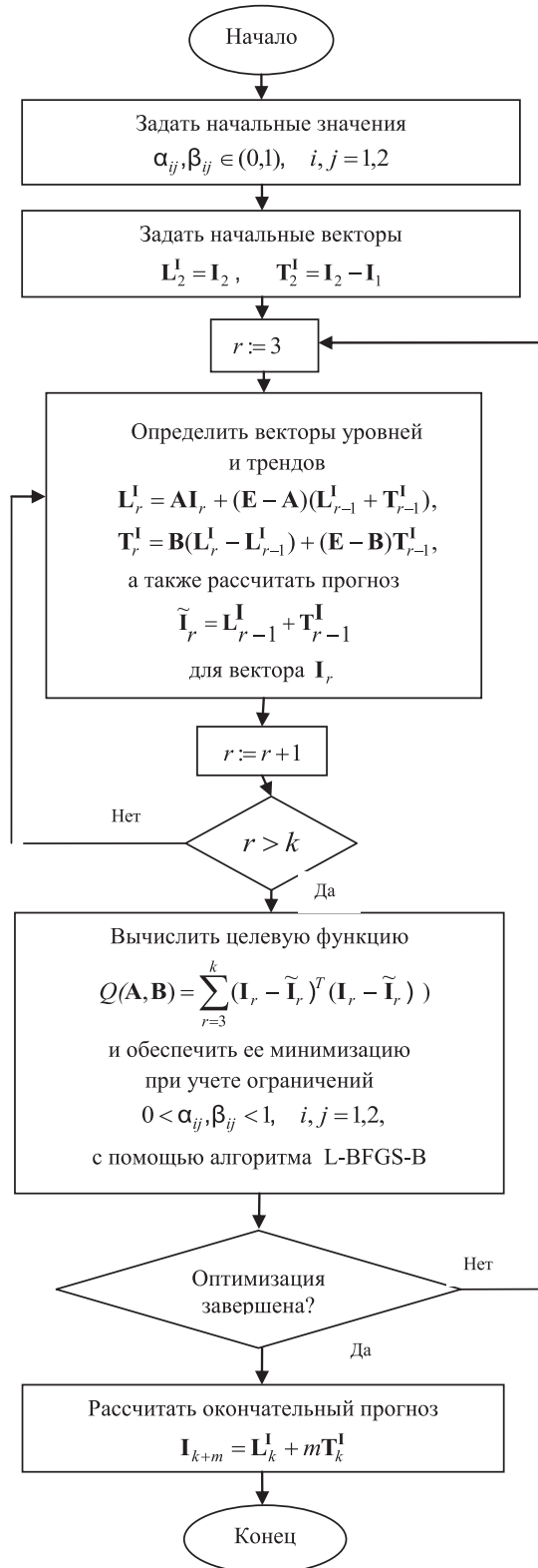
Блок-схема алгоритма прогнозирования с помощью ИВР-модели, где \mathbf{I}_{k+m} = [\underline{Y}(k+m), \bar{Y}(k+m)]^T
