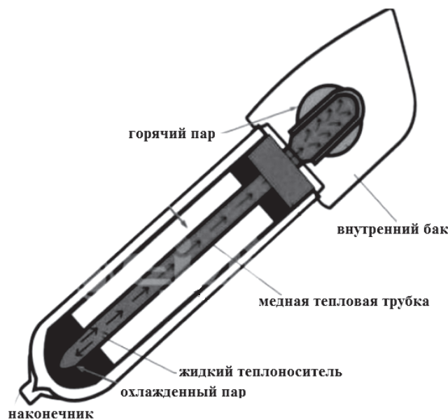
Рис. 1. Конструкция нагревательного элемента солнечного коллектора
