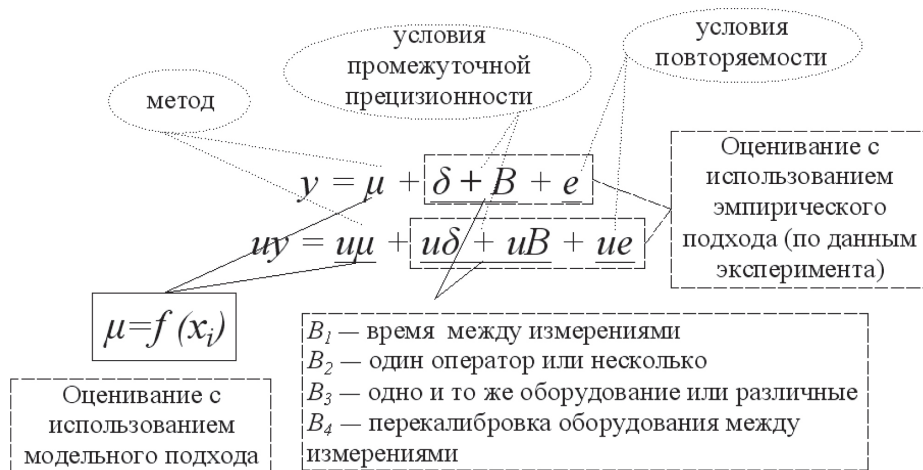
Рис. 1. Комбинированный подход к оцениванию неопределенности результата измерений в соответствии с базовой статистической моделью [4]
