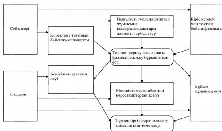
1 –ші сурет. Түрлендіргіштердегі электромагниттық процестердің өзара байланысы және олардың техно-экономикалық көрсеткіштерге әсері.
