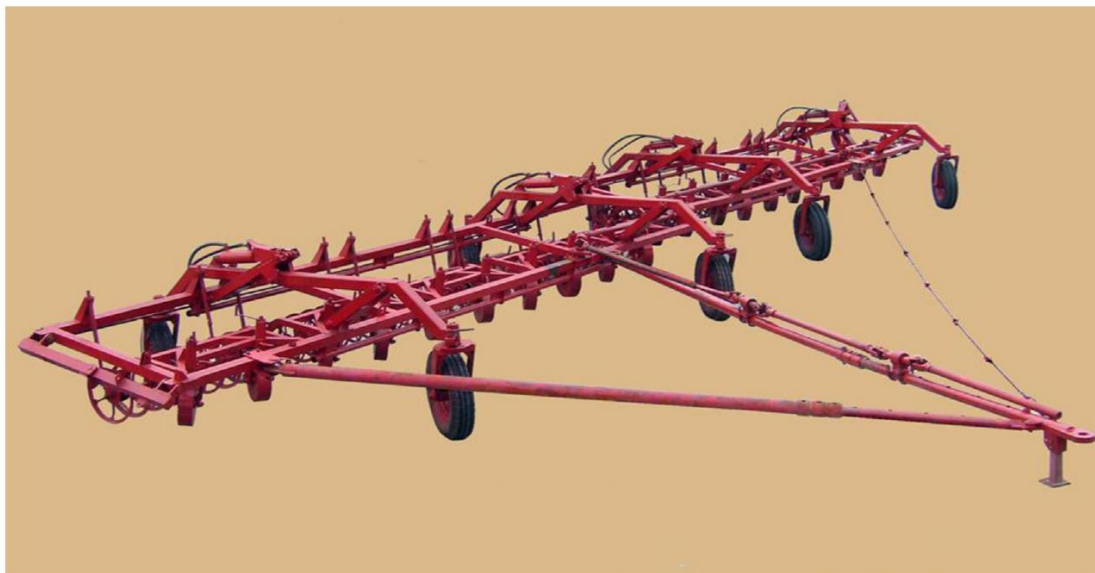
Рис. 1. Экспериментальный образец орудия с активным приводом ротационных рабочих органов
