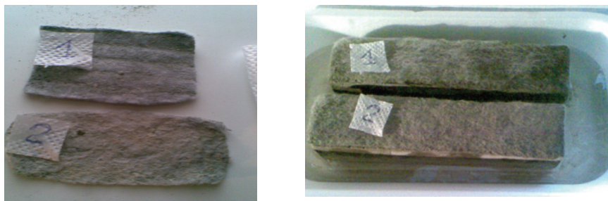
Рис. 7. Зависимость водопоглощения гидроизоляционных составов от наполнения его полимерной фиброй:
