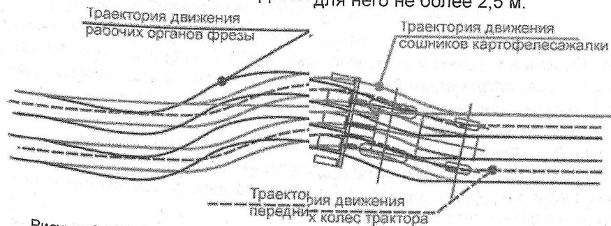
Рисунок 3 – Траектории движения агрегатов при посадке и нарезке гребней
