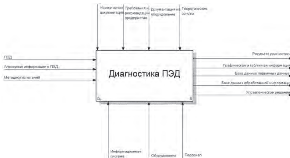
Рис. 1. Контекстная диаграмма функциональной модели диагностики
