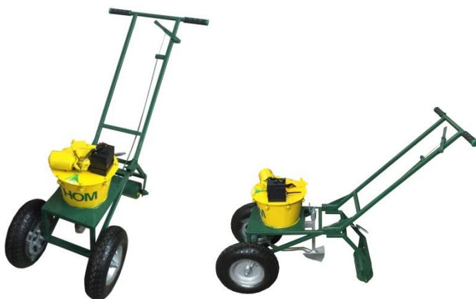
Рисунок 2. – Сеялка рядкового высева семян овощных культур: а – вид спереди; б – вид сбоку
