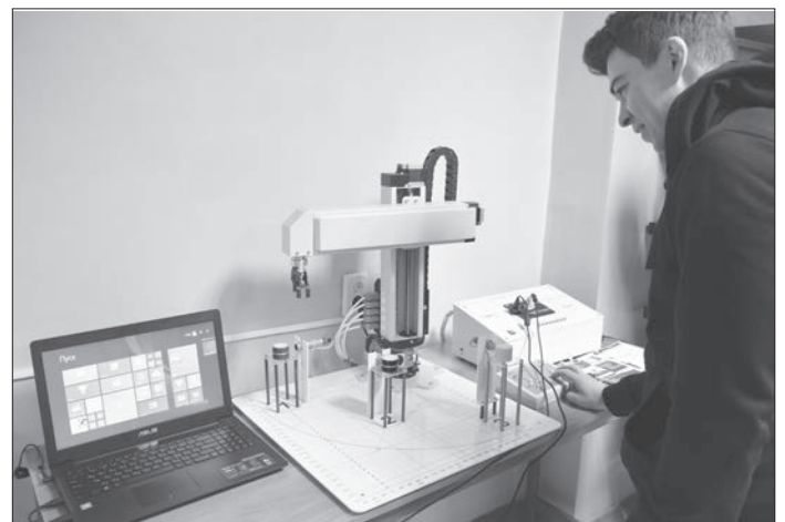
САУ-Робот-НН стенд автоматизации и управления робота – манипулятора освоено выполнение двух лабораторных работ по дисциплине «Системы управления в машиностроении» для 2-3 курсов специальности «Аграрная техника и технология»»
