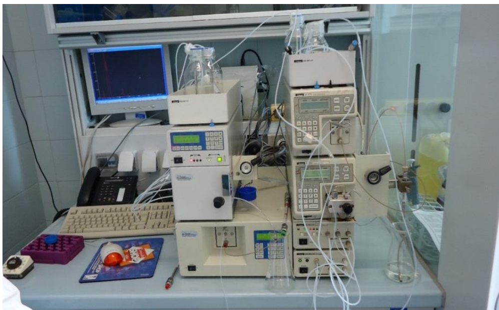
Рисунок 8 – Высокоэффективный жидкостный хроматограф с масс-спектрометрическим детектором Лаборатория фармакологии ветеринарной школы университета г.Пизы Италия
