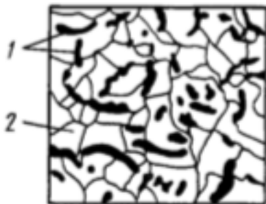
45-сурет. Вермикулярлық графитті ферриттік шойынның микроқұрылымы: 1 - вермикулярлық графит, 2 – феррит
