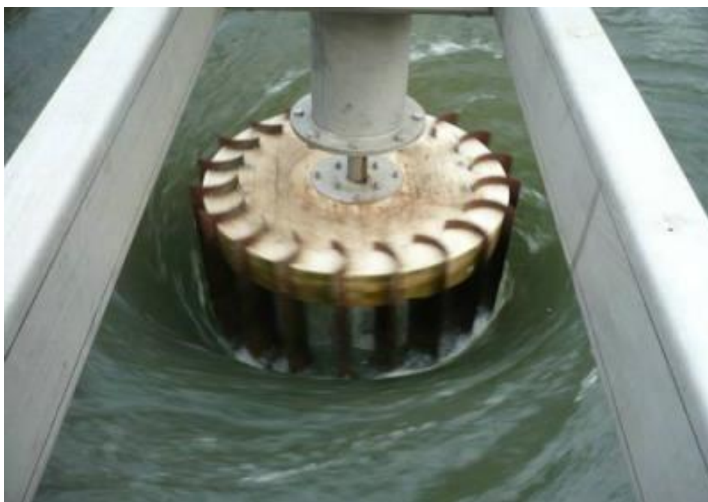
Рисунок 4 – Конструкция МГЭС с вертикальным ротором
