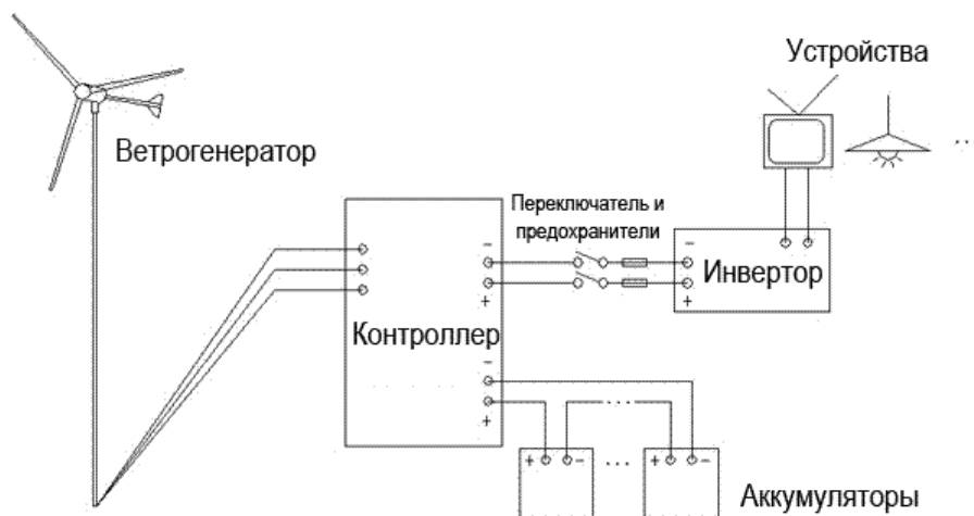
Рисунок 9 – Схема автономного обеспечения объекта (с аккумуляторами)
