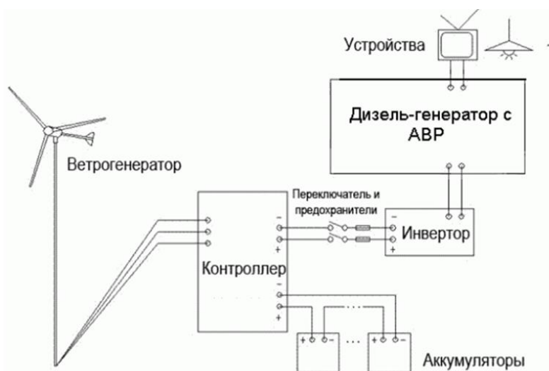
Рисунок 10 – Схема ветрогенератора и коммутацией с сетью
