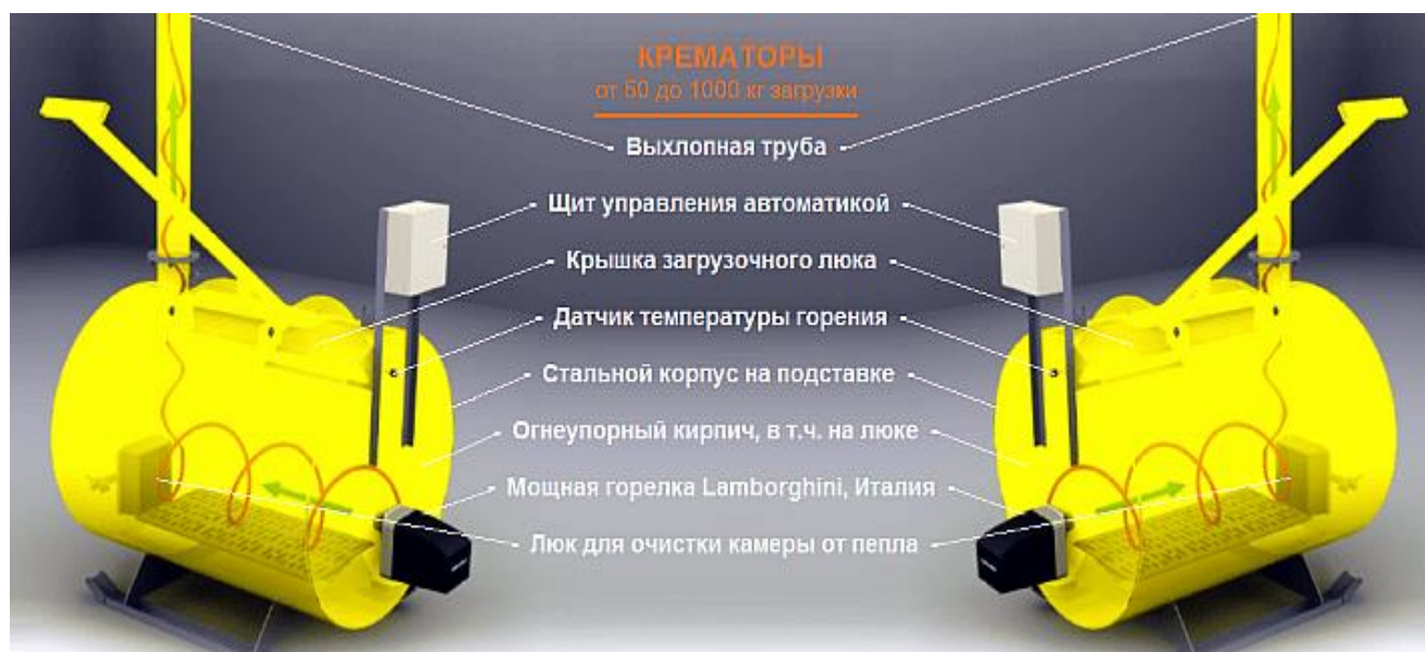
Рисунок 4 - Устройство крематоров для животных
