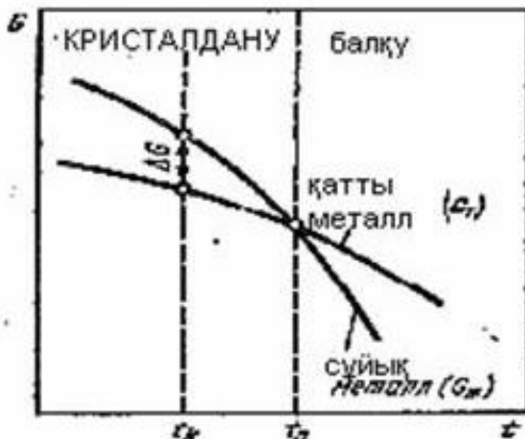
18 сурет - Қатты G_K және сұйық G_M күйдегі металда температураға тәуелді Гиббс энергиясының өзгеруі
