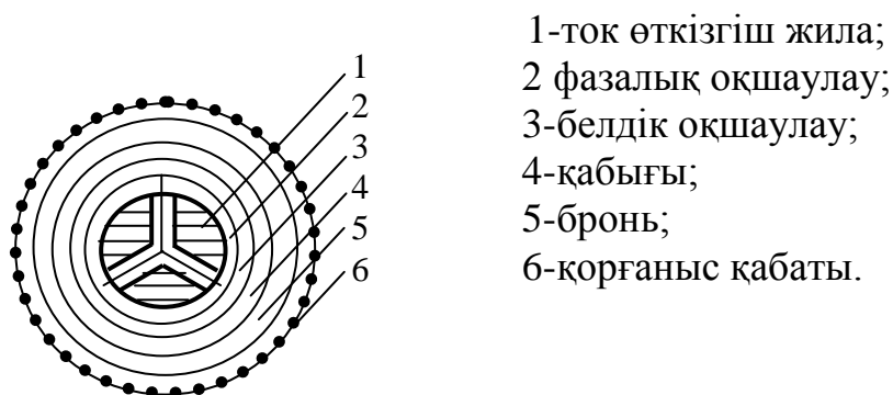
Сурет 10-Кернеуі 10 кВ кабель конструкциясы.
