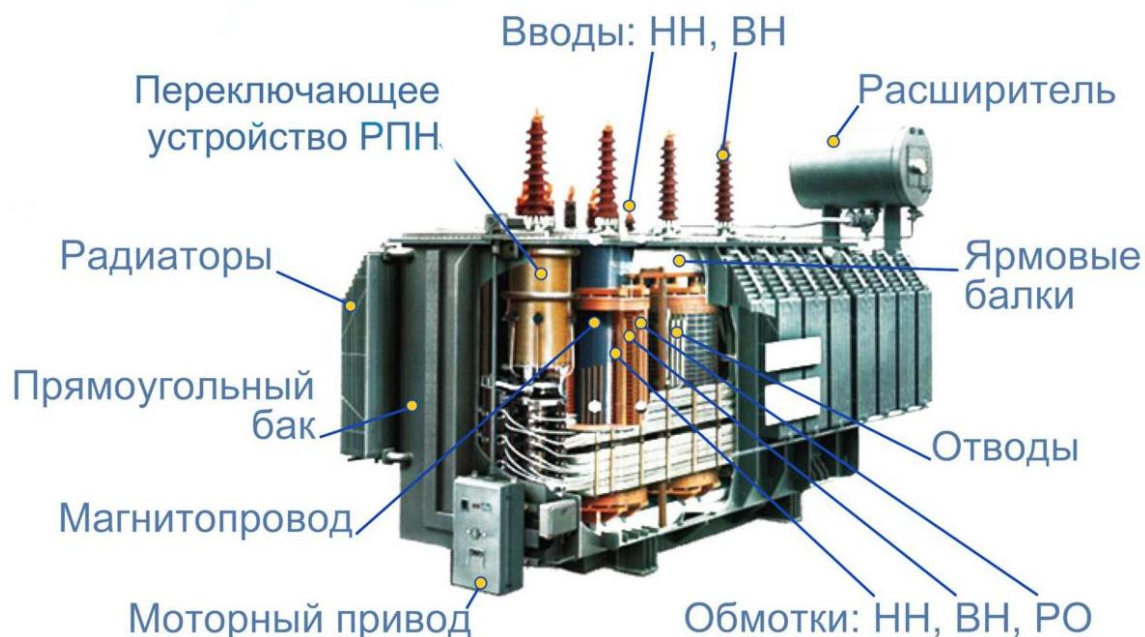
Рисунок 12 – Внешний вид силового трансформатора выше 110 кВ с РПН
