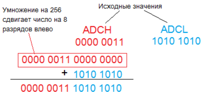
Рисунок 68 – объединение старшего и младшего байтов
