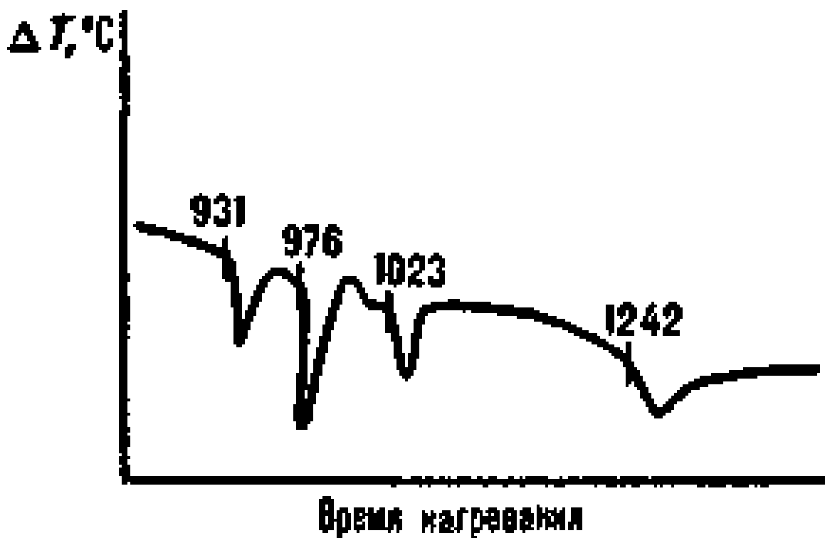
Кривая ДТА сверхпроводника \text{HoBa}_2\text{Cu}_3\text{O}_{685} . Числа обозначают m -рупечи ( ^\circ\text{C} ), скорость нагрева 10\text{ }^\circ\text{C}/\text{мин}
