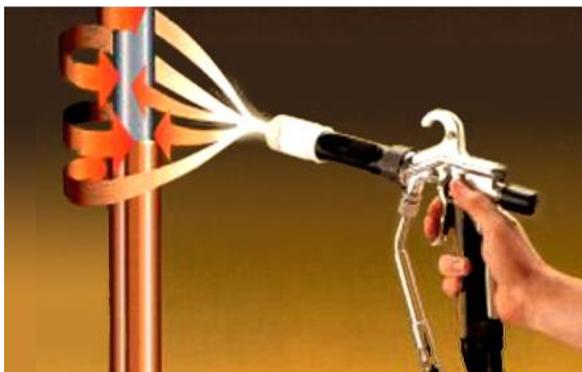
Рисунок 13.4. – Окрашивание в электростатическом поле
