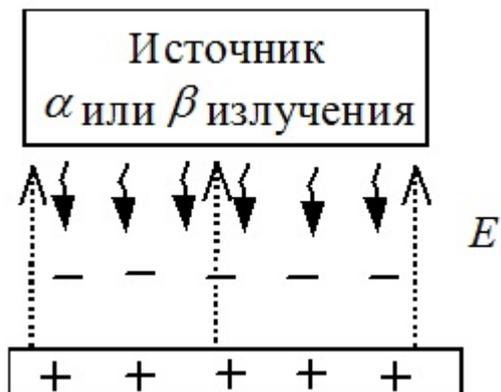
Рисунок 13.3. – Действие радиоактивного нейтрализатора статического электричества
