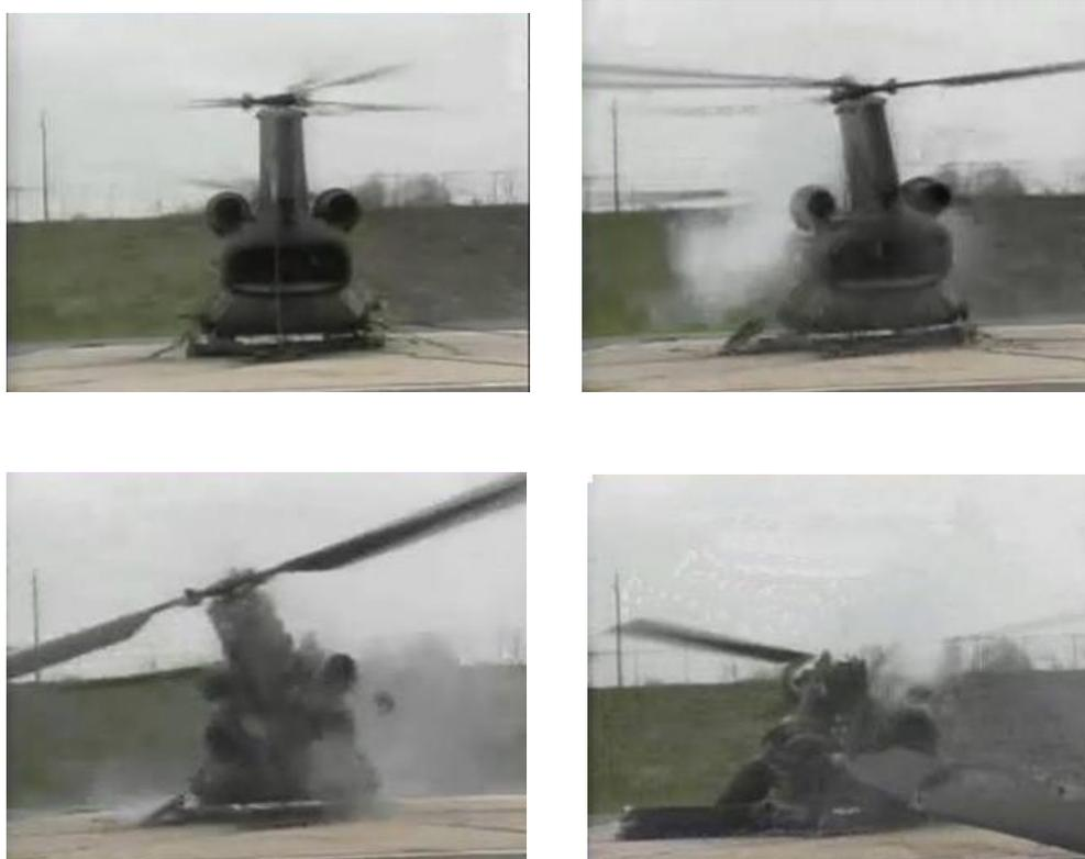
Рисунок 7.5 – Резонансное разрушение вертолета
