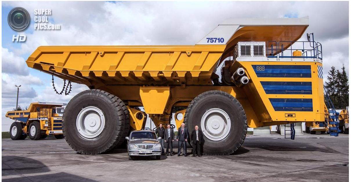
Рисунок 1.11. – Выпущенный на заводе ОАО «БелАЗ» (Белоруссия), самый крупный в мире по размеру и грузоподъемности карьерный самосвал Грузоподъемность—450 тонн! Это рекорд, ближайшие конкуренты из Америки и Европы способны максимум на 363 тонны.
