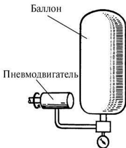
Рисунок 6.6. – Аккумулятор давления.
