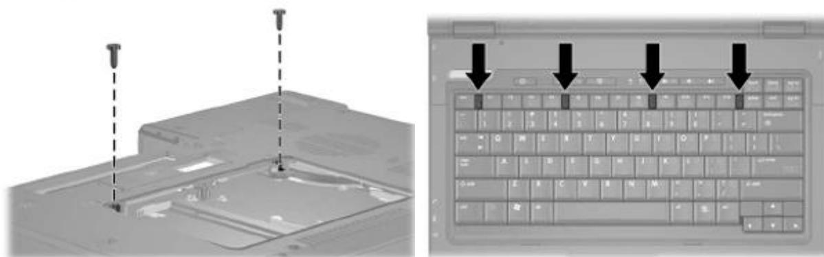
Рисунок 30. Клавиатура может крепится только на защелках
