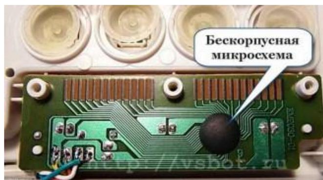
Рисунок 38. Микросхема клавиатуры
