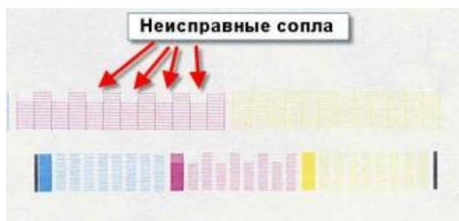
Рисунок 20. Неисправные сопла
