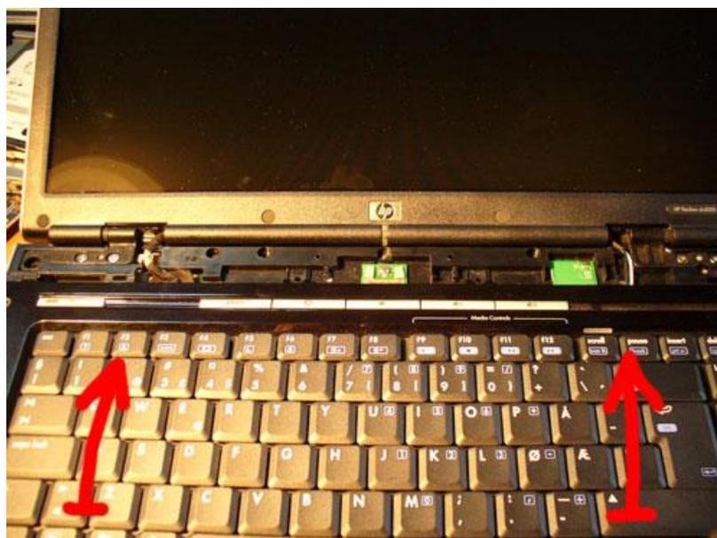
Рисунок 27. Здесь крепеж верхней панели находится под «ушами»
