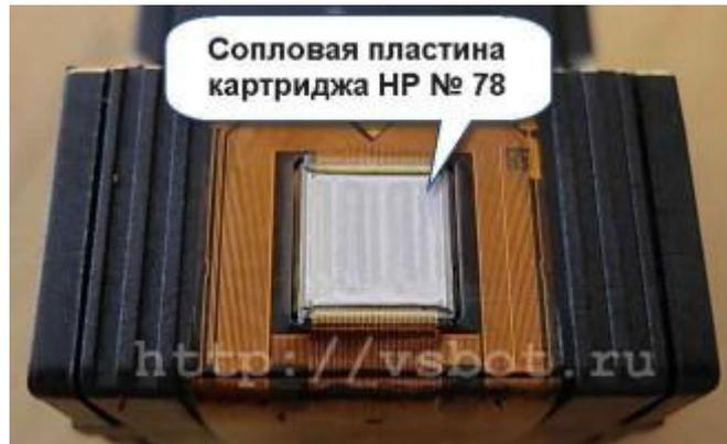
Рисунок 21. Сопловая пластина
