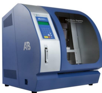
Рисунок 7 – Автоматизированная система для выделения нуклеиновых кислот из клеток Automate Express DNA extraction system
